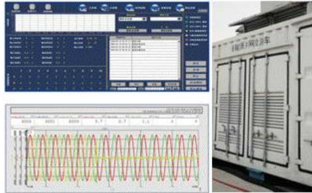
6/10kV/6MVA 储能测试平台
